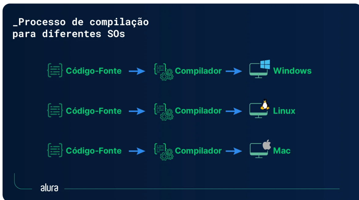
Figura 7 – Processo de Compilação sem Utilização de JVM
