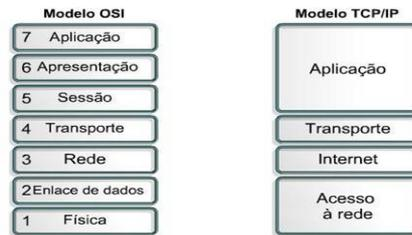
Figura 2.2: Modelo ISO x TCP IP
